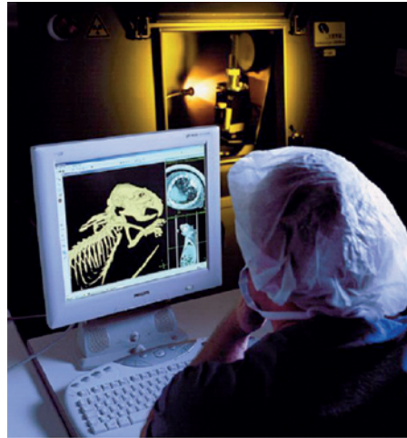
Abb. 2: Mithilfe des Mikrocomputertomographen werden Skelettfehlbildungen visualisiert und vermessen.
